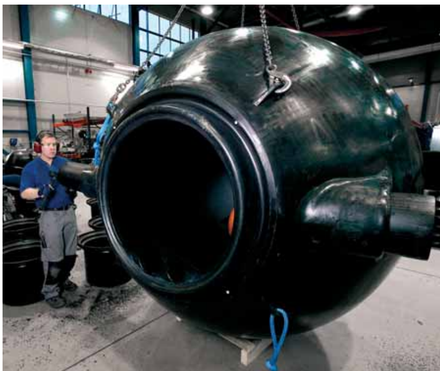
Polyeteeninen erotin on kevyt, ja pallomainen muoto mahdollistaa erottimen täydellisen tyhjentämisen.
