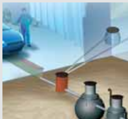
Erotinjärjestelmä henkilöautojen käsinpesupaikalle
