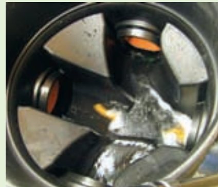
TEGRA 600 -kaivolle tehtiin kattava virtaustestaus, jotta kaivon virtausominaisuudet saatiin optimaaliseksi.
