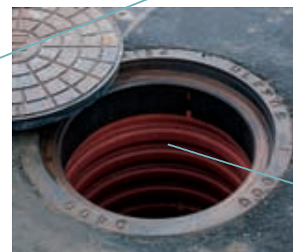
11 Kaivo voidaan asentaa myös ilman teleskooppiä; tällöin tiiviste (kuva 7) asennuksen jälkeen kaivon voidaan asentaa suoraan ns. kelluva kansisto. Kansistossa on teleskooppinen kehys, joka asennetaan suoraan 600 mm:n korrugoidun nousuputken päälle.
