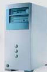
LabkoNet-palvelin Kerää hälytykset ja muokkaa niiden sisältämän tiedon lähetettäväksi eteenpäin joko tekstiviestinä tai sähköpostina.
