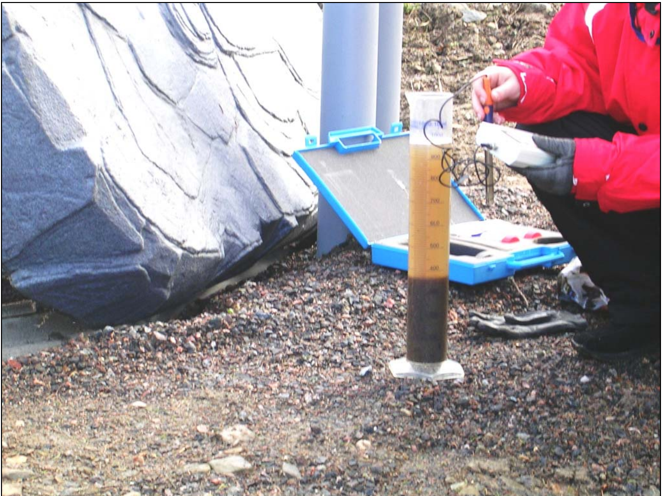
Panospuhdistamon ilmastuslietteen laskeutuskoe ja pH-mittaus.
